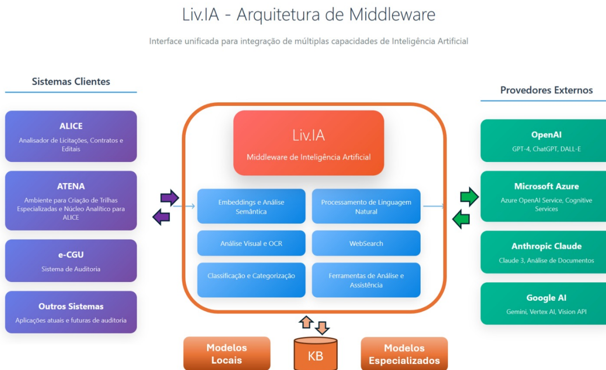
FIGURA 1 - VISÃO GERAL LIV.IA - MIDDLEWARE PARA INTEGRAÇÃO NOTA: KB – BASE DE CONHECIMENTO OU KNOWLEDGE BASE
